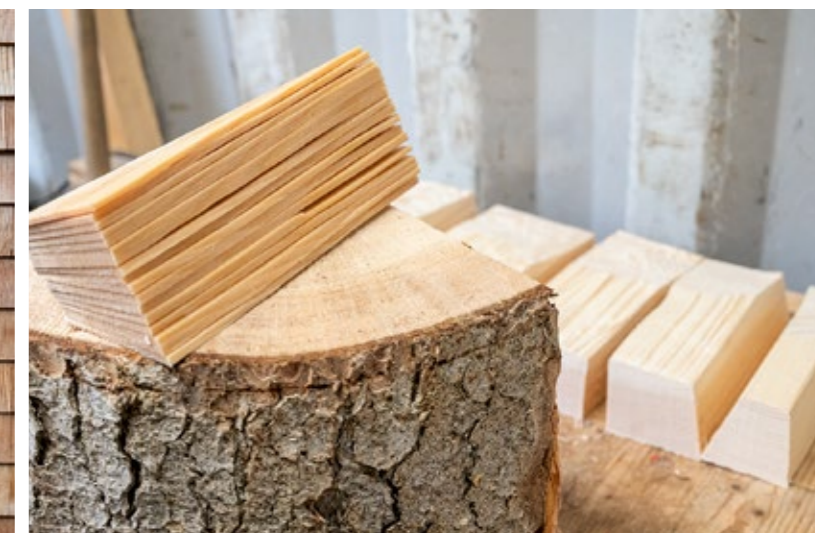
Linke Seite: Werner Altherr entfernt am Schindelbock die HolZRinde vom Holzschicht. Oben rechts: Die fertigen Holzschindeln aus idealem Tannenholz. Links: Glattschirm (oben) und Schlaufschirm sind im Appenzellerland am häufigsten anzutreffen.
